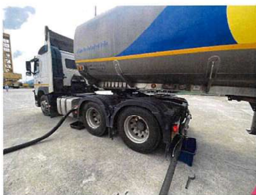
ภาพถ่ายที่ 2.2-10 ถาดรองรับน้ำมัน และเจ้าหน้าที่กำกับดูแลขณะถ่ายน้ำมัน
